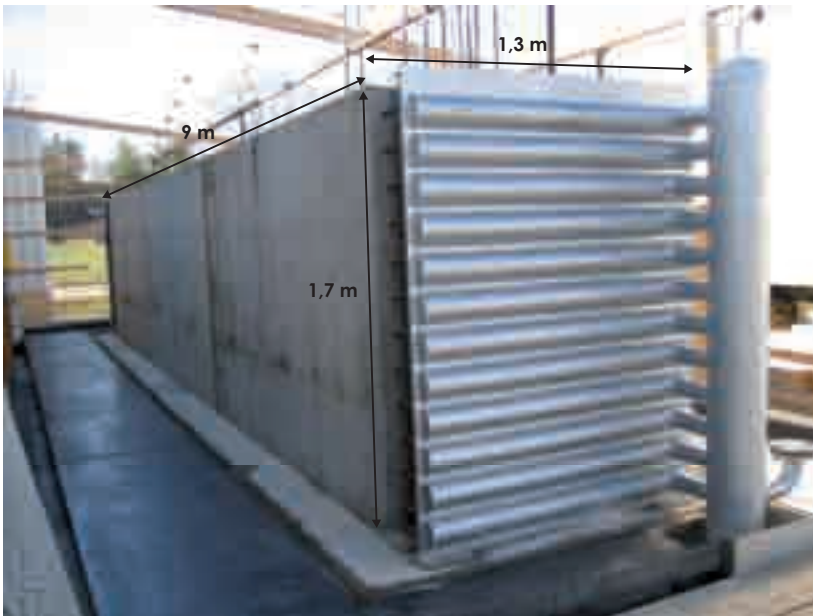
Foto 2. Prototipo de sistema de almacenamiento térmico en hormigón, de 400 kWh de capacidad.
