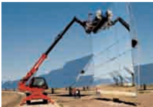
Foto 22. Desarrollo final basado en cepillo giratorio para limpieza de espejos.
