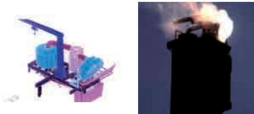
Figura 2. Esquema de distribución de elementos del proyecto TSA (Receptor, Generador de Vapor y Tanque de Almacenamiento Térmico) y funcionando en pruebas la torre Cesa-1 de la Plataforma Solar de Almería.
