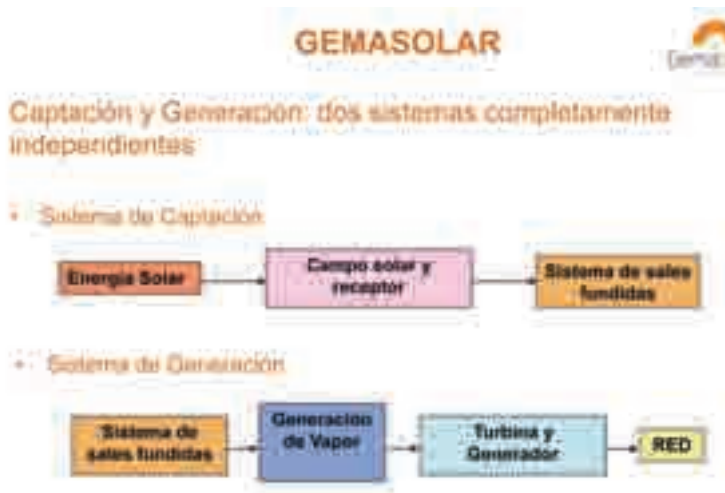
Figura 2. Sistemas de captación y generación en Gemasolar.
