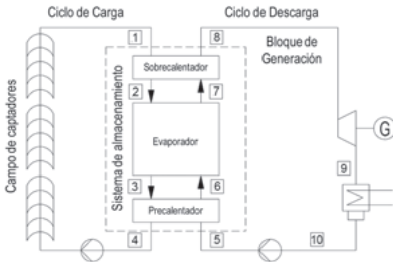
Figura 9. Esquema de un sistema de almacenamiento segmentado. Fuente: Steinmann et.al., 2007.
